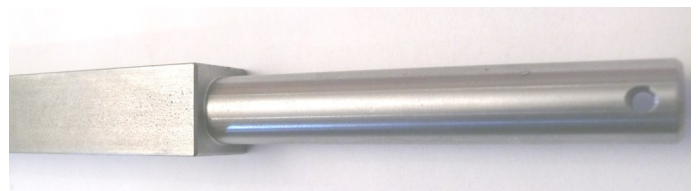
Achse verbessert, Achszapfen angedreht
